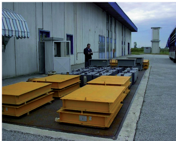
40t di Masse Campione utilizzate durante una verifica periodica di una pesa a ponte
