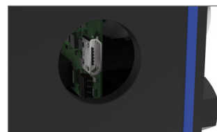
MICRO-USB FÜR DIE KONFIGURATION VOM PC
