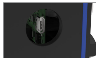
MICRO USB PARA LA CONFIGURACIÓN MEDIANTE PC
