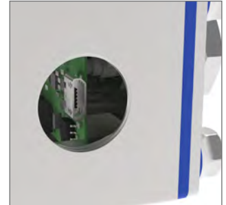
MICRO-USB FÜR DIE KONFIGURATION VOM PC
