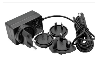
Alimentation universelle incluse 24 VDC/1 A - entrée 100÷240 VAC longueur de câble 3 m
