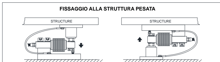
POSSIBILI POSIZIONI DELLA PIASTRA SUPERIORE
